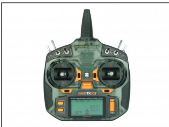
Rádiový systém OrangeRx Tx10i kompatibilní s DSMX, režim 1, verze pro EU, 10 kanálů, 2,4 GHz
